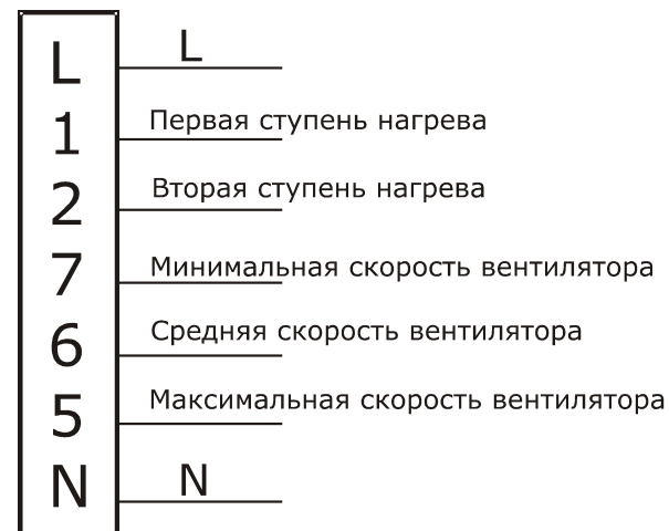
Рис. 4. Электрическая схема подключения пульта управления
