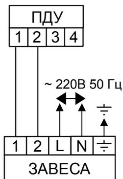
**Подключить сетевой кабель и ПДУ согласно маркировке рядом с клеммной колодкой.**
