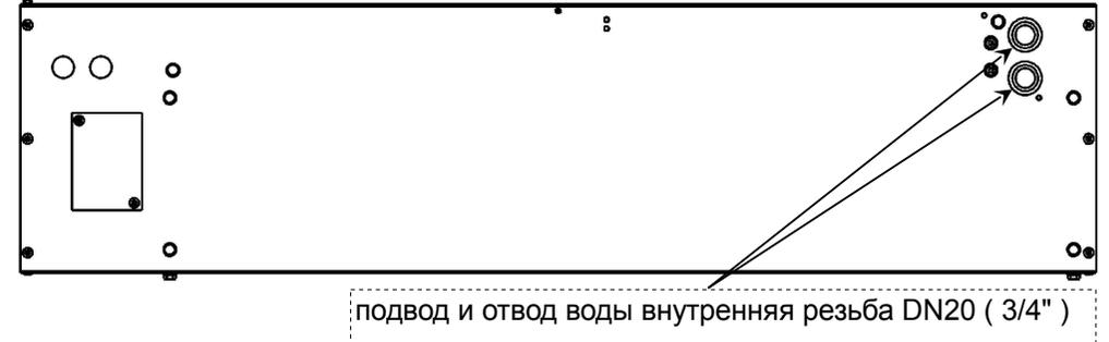
Завеса рассчитана на установку горизонтально и вертикально, но необходимо учитывать возможность слива воды и образования воздушных пробок. Оптимальное расположение линий подвода и отвода воды должен определить *квалифицированный* сантехник.
