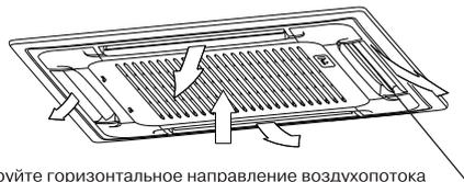
Отрегулируйте горизонтальное направление воздушного потока
