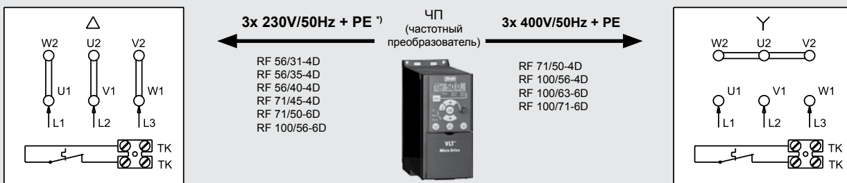
Рисунок 7 – включение в звезду/треугольник (Y/Δ) 3-хфазного электромотора мотора с частотным преобразователем, защита IP21 (RFFMIMxxx20)
